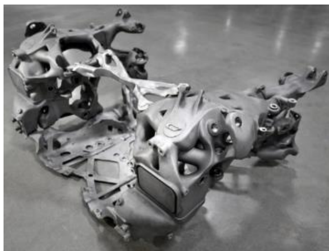
Figura 6.7. Structura din spate asamblată, care arată măsura în care fabricarea aditivă a metalelor a fost utilizată pe 21C
