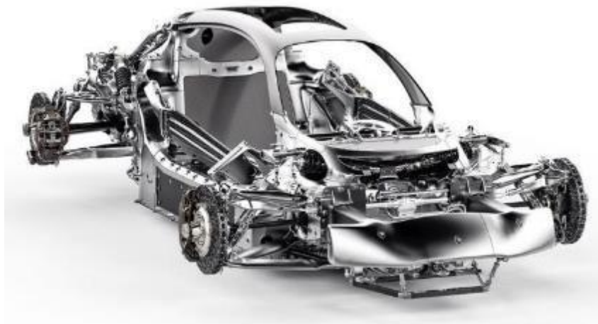
Figura 6.8. Structurile de siguranță din față, suspensiile și sistemele de frânare, toate care folosesc inteligența artificială pentru a optimiza designul componentelor pentru performanță, profitând în același timp de oportunitățile prezentate de AM
