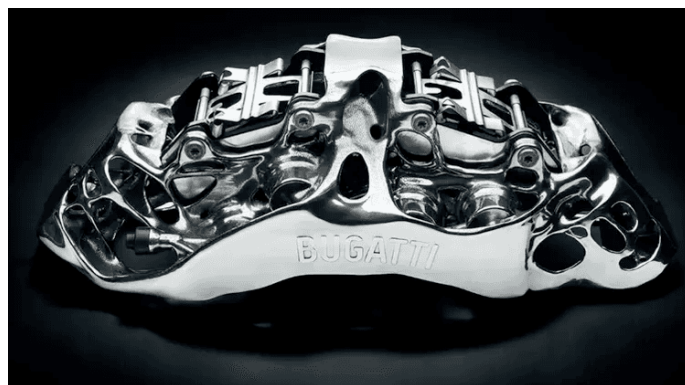
Figura 6.5. Etrierul de frână monobloc cu opt pistoane de la Bugatti este cea mai mare piesă de mașină funcțională din titan imprimată 3D din lume.
